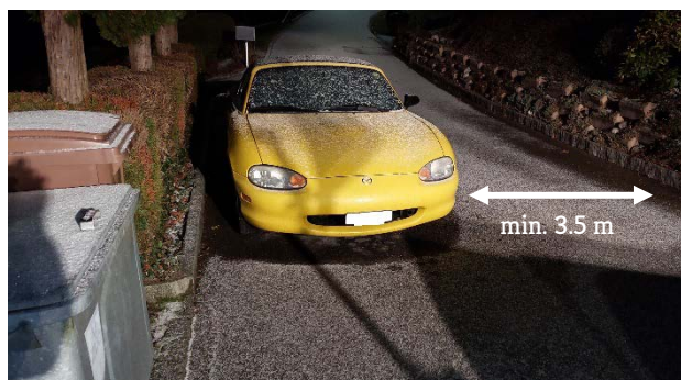
Illustration de la distance minimale à respecter. Ce qui n'est pas le cas dans cette situation.
